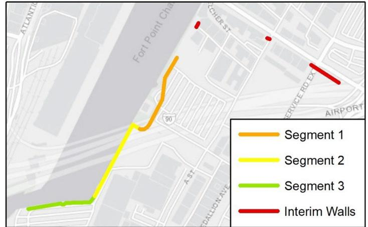
它還包括 Necco Court 西端和 Summer Street 下方位於 A Street 和 West Service Road 的臨時防洪牆。這些防洪牆只會在預測發生重大沿海洪水事件時臨時安裝。這些結構的頂部將比基於百分之一概率的 FEMA 防洪堤標準高出 1.5 英尺。在接下來的 10 到 20 年內，一旦沿南波士頓濱水區其他高危地段的防洪系統建成，臨時防洪牆將不再需要。
